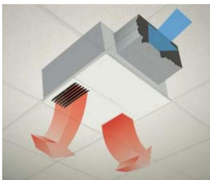
Gehäuse aus feuerverzinktem Stahlblech gefertigt, mit Anschlußöffnung für saugseitiges Kanalzubehör innerhalb der Zwischendecke. Abdeckung, unterteilt mit Ausblasgitter, gefertigt aus elektrolytisch verzinktem Stahlblech, pulverbeschichtet RAL 9010.
