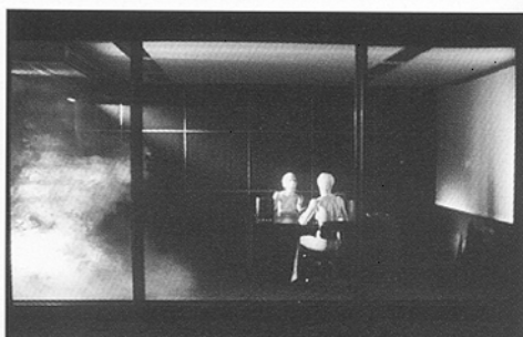
Odchylenie strugi powietrza przy podłodze
